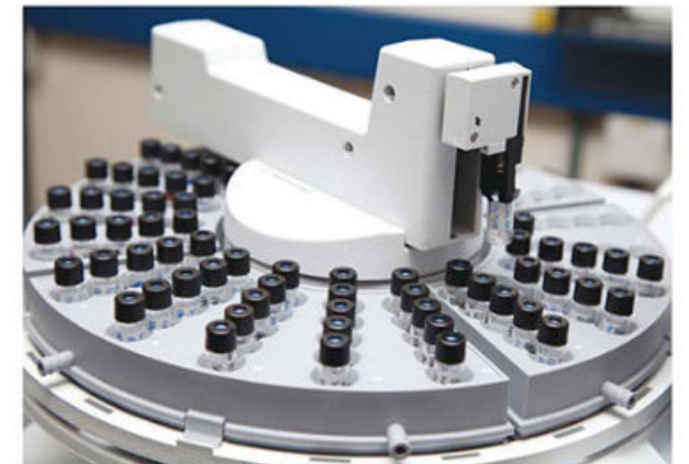
Figura 1.44 El cromatógrafo de gases se utiliza para separar los distintos componentes de una muestra.
