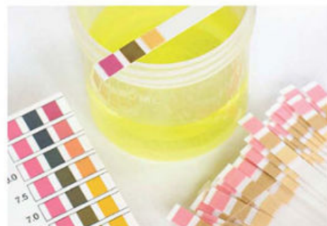
Figura 4.7 Los medidores de pH se sirven de sustancias conocidas como "indicadores". Estas sustancias cambian de color de acuerdo al pH del medio.
