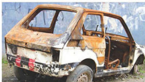
Figura 4.32 La corrosión se provoca por el desprendimiento gradual de la capa superficial de un material causada por la exposición a un ambiente que pueda provocar una reacción química; este proceso se puede evitar protegiendo el material de distintas formas.
